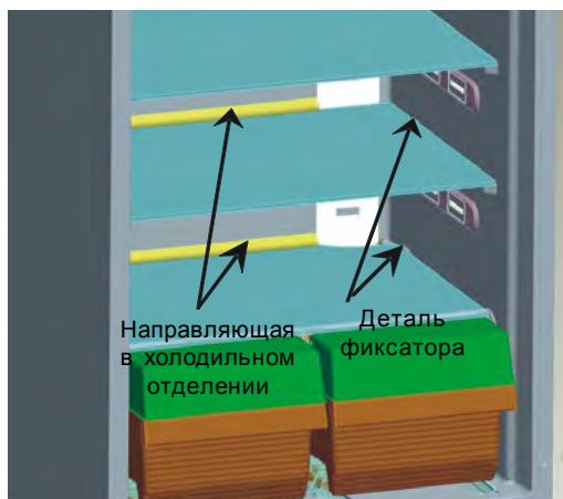
При установке и извлечении стекла ящика для фруктов и овощей и полок холодильной камеры убедитесь, что стеклянные полки полностью фиксированы в направляющих на задней стенке корпуса холодильника и с подвесных деталях с боков.
